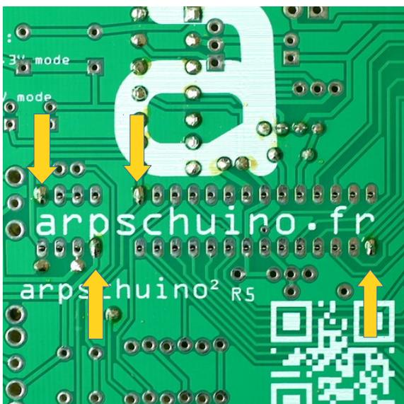
On va ensuite mettre en place les supports de circuits intégrés en faisant bien attention à mettre l'encoche dans le sens indiqué sur la sérigraphie. Pour les mettre en place on commence par faire un point de soudure à chaque extrémité, comme sur la photo.
