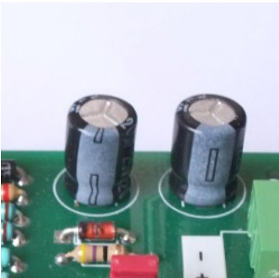
Les condensateurs chimiques sont polarisés. Le côté négatif est noté en clair sur le corps du condensateur et la patte est plus courte. Il est marqué aussi sur le circuit imprimé. Attention un condensateur chimique monté à l'envers peut exploser ! Sans grand danger mais ça surprend !
