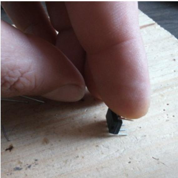
Il ne reste plus qu'à clipper les circuits intégrés (sn65hvd08P et Atmega 328). Les pattes sont parfois un peu écartées et il peut être nécessaire de les resserrer un peu avec les doigts.
