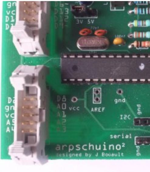
Enfin les connecteurs HE10 pour les nappes. La fente doit être tournée vers l'intérieur de la carte. On peut faire comme pour les circuits intégrés, commencer d'abord par les 2 extrémités et vérifier avant de souder les autres pattes.
